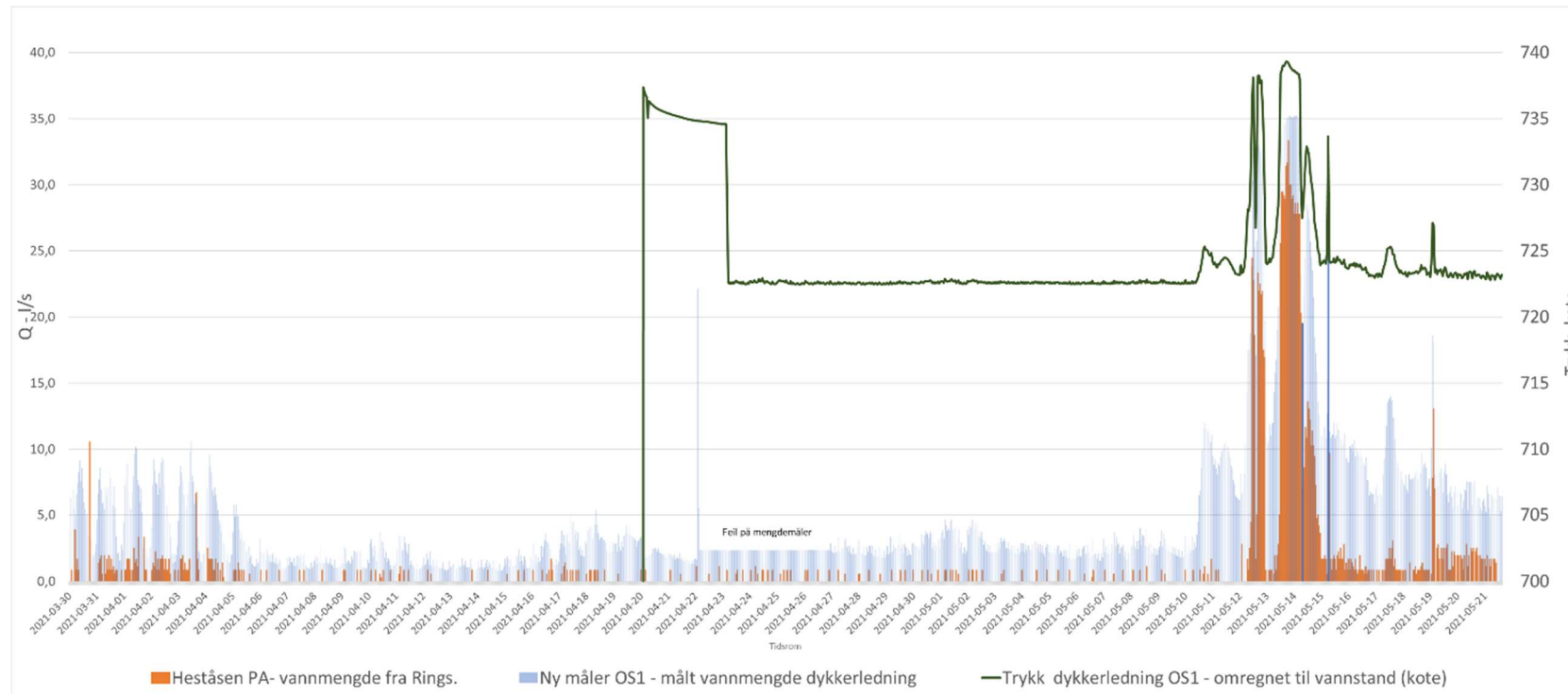
Figur 2.1 Avløpsmengder fra Nordseter (blå søyler) og Ringsaker (oransje), samt målt trykk i dykkerledningen ved kum OS1 (grønn linje). Diagrammet viser at det hovedsakelig er små mengder avløp som kommer fra Ringsaker. Unntaket er under snøsmeltingsperioden hvor det en periode ble overført store mengder avløp fra Sjusjøen.
